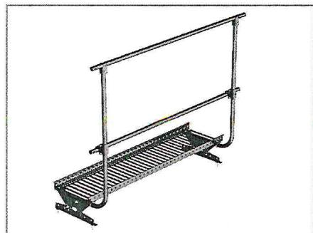
После монтажа регулировочного кронштейна на него сверху установить платформу переходного мостика (не входит в комплект поставки) и зафиксировать ее болтами. Опору ограждения закреплять к платформе переходного мостика.
